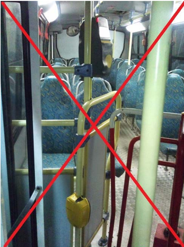
Imagem 4.2.15 – Validador na altura da roleta e Finger na escada.
